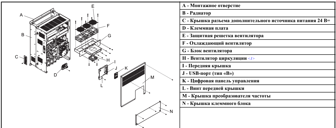
Табл. 1.7 Детали преобразователя частоты в исполнении IP00 в разобранном виде (CIMR-A□4A0362A)
