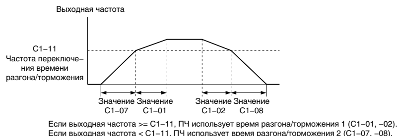
Рис. 5.31 Переключение времени разгона/торможения в зависимости от частоты
