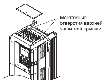
Рис. 3.19 Установка верхней защитной крышки
