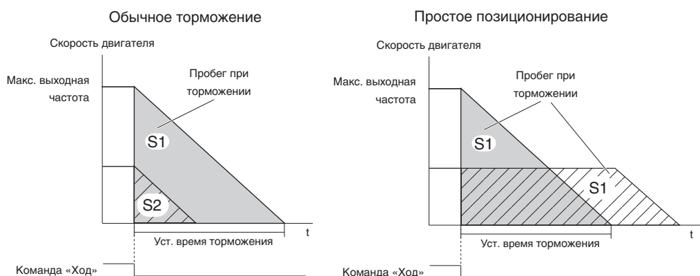
Рис. 5.8 Торможение с простым позиционированием
