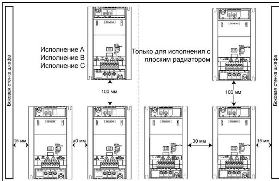
Рисунок 1-1 Монтажные зазоры
