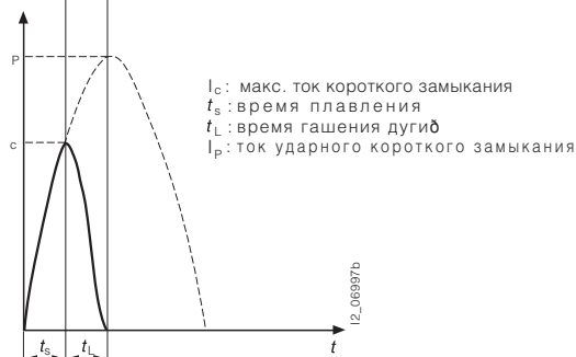
Осциллограмма отключения тока короткого замыкания плавкой вставкой предохранителя
