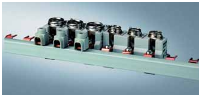
цоколи 3-полюсные D01 и D02 исполнения зажимов В и К сборная шина 5SH5 320 зажим 5SH5 328 торцевые крышки 5SH5 514
