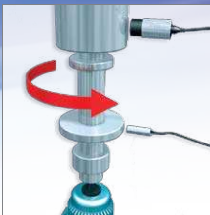
▲ Контроль эксцентриситета вращающегося вала
