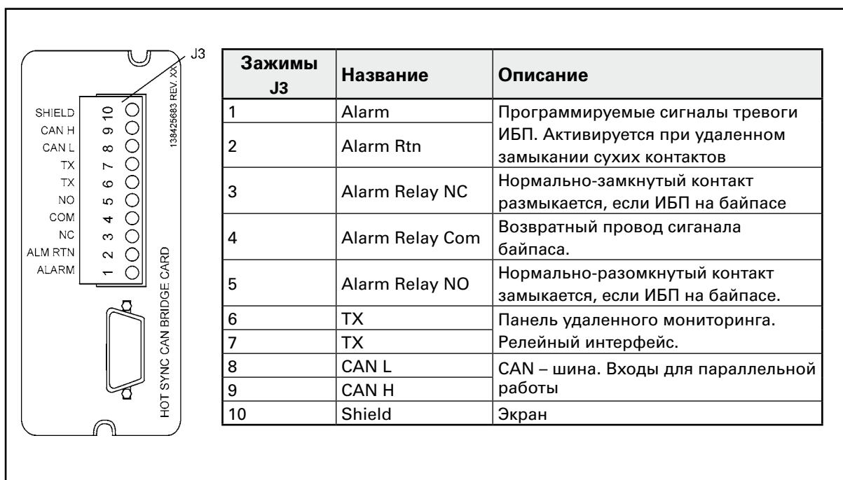
Рисунок 26 Адаптер XSlot Hot Sync и контактный интерфейс
