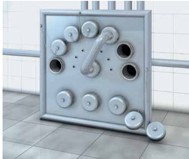
Контроль положения переключки разделительного узла на линии по производству напитков.
