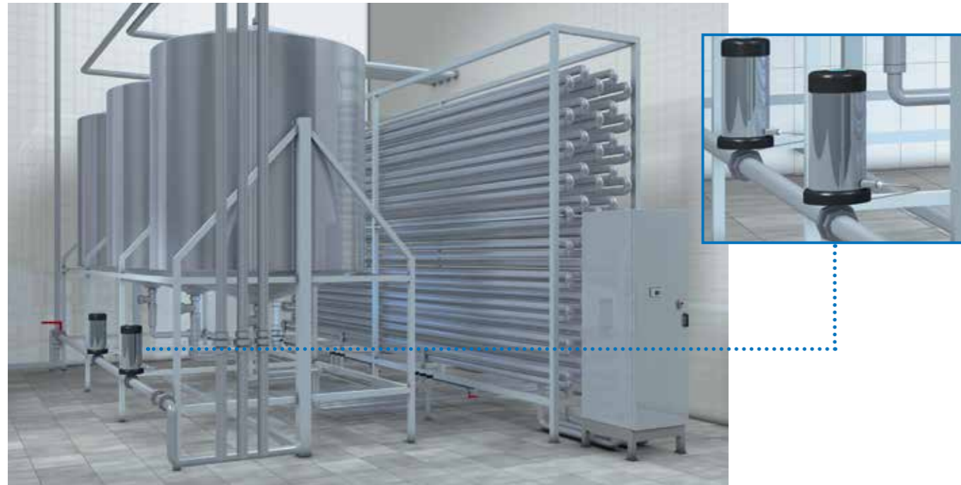
Контроль положения клапанов мешалок или нагревателей.
