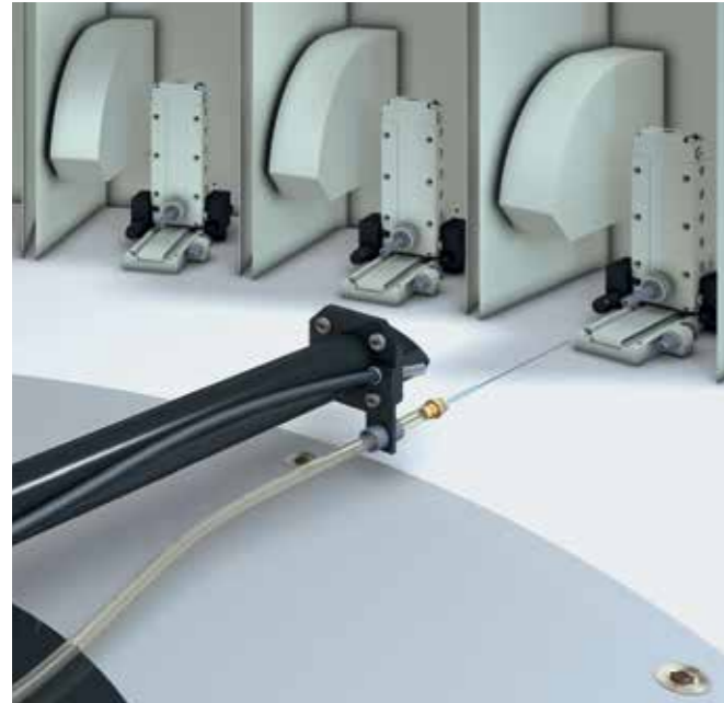
Контроль положения захватного устройства робота.
