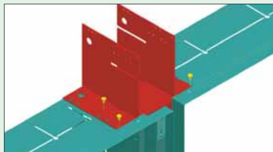
Крестообразное соединение четырех шкафов (2 x 2)
