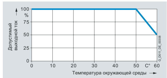
Высокая перегрузка (high overload HO) для силовых модулей PM230 типоразмеров FSA до FSF
