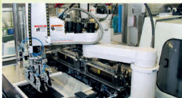
2 SCARA-робота для захвата и переноса
