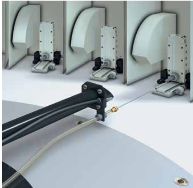
Контроль положения захватного устройства робота.
