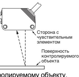
Однако, если контролируемый объект имеет глянцевую поверхность, следует наклонить датчик на 5° - 10°, как показано на рисунке, убедившись в том, что датчик не подвергается воздействию объектов, расположенных на заднем плане.
