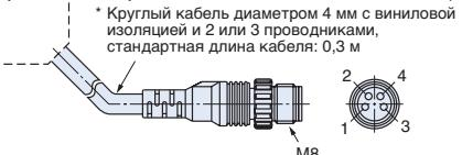
\* Кабель излучателя имеет два проводника, кабель приемника – три проводника.
