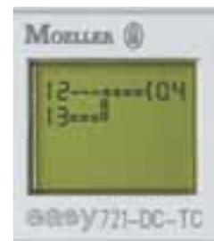
Подсветка схемы соединения в режиме выполнения программы указывает на логическое состояние элементов ==элемент активен
