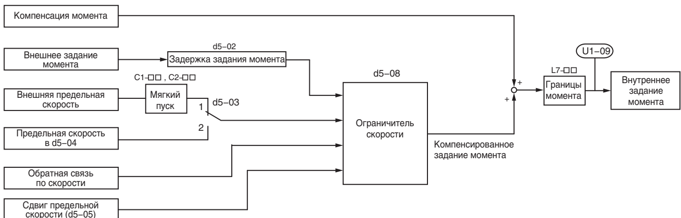
Рис. 5.50 Структурная схема функции регулирования вращающего момента
