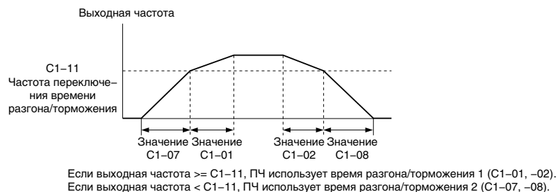
Рис. 5.31 Переключение времени разгона/торможения в зависимости от частоты
