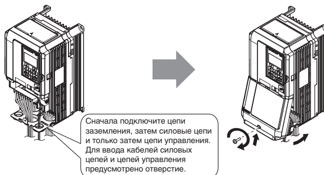
Рис. 3.8 Установка крышки клеммного блока для ПЧ в корпусе IP20/NEMA, Тип 1
