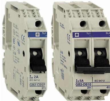
Помимо выполнения защитных функций автоматические выключатели GB2 отвечают требованиям к изоляции, в выключенном состоянии они обеспечивают гарантированный разрыв и соответствие положения подвижных контактов автоматического выключателя положению рукоятки управления.
