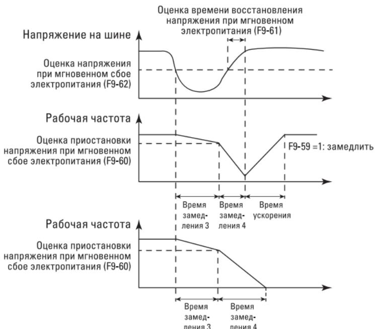
Рис. 6-25. Схема действия при мгновенном сбое электропитания
