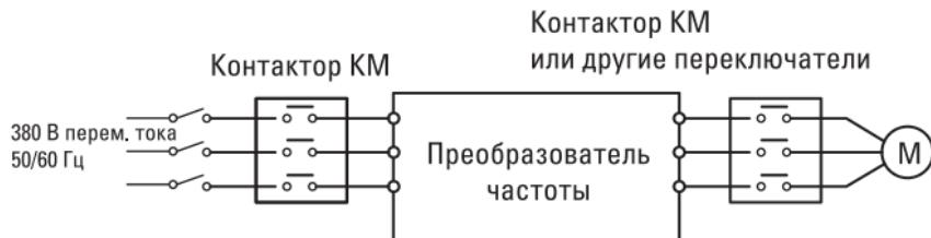
Не допускается пуск/останов привода переменного тока путем включения/выключения контактора. Если контактор управляет приводом переменного тока, следите за тем, чтобы временной интервал составлял не менее 1 часа.
