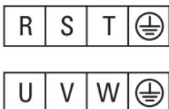
Рис. 3-1. Клеммы основного контура 0,75–2,2 кВт
