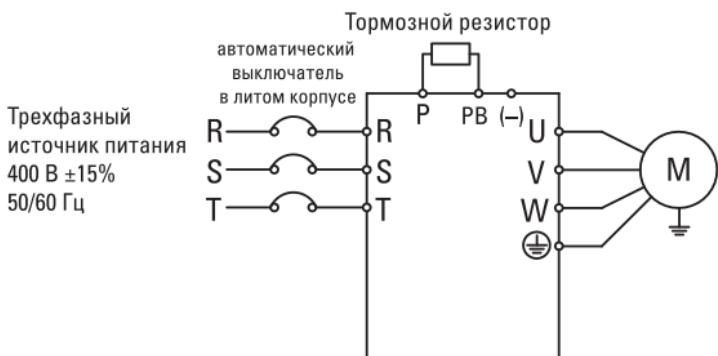
Рисунок 3-5. Стандартное трехфазное подключение 0,75–11 кВт
