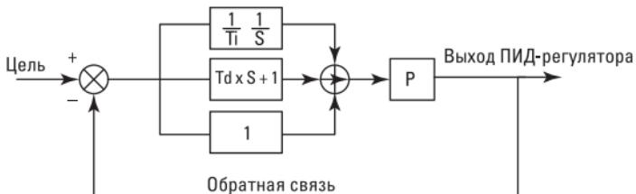
Рис. 6-26. Схема принципов работы технологического ПИД-регулятора
