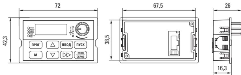
Рис. 7-2 Габаритные размеры интегрированной клавиатуры
