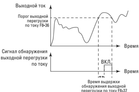
Рис. 6-22. Схема тестирования на превышение порога выходного тока
