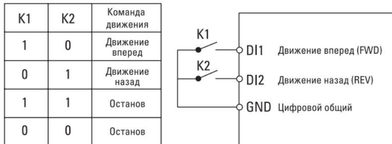
Рис. 6-6. Двухпроводной режим 1
