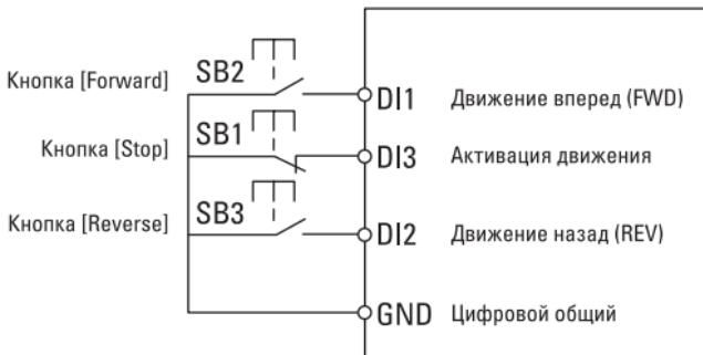
Рис. 6-8. Трехпроводной режим управления 1
