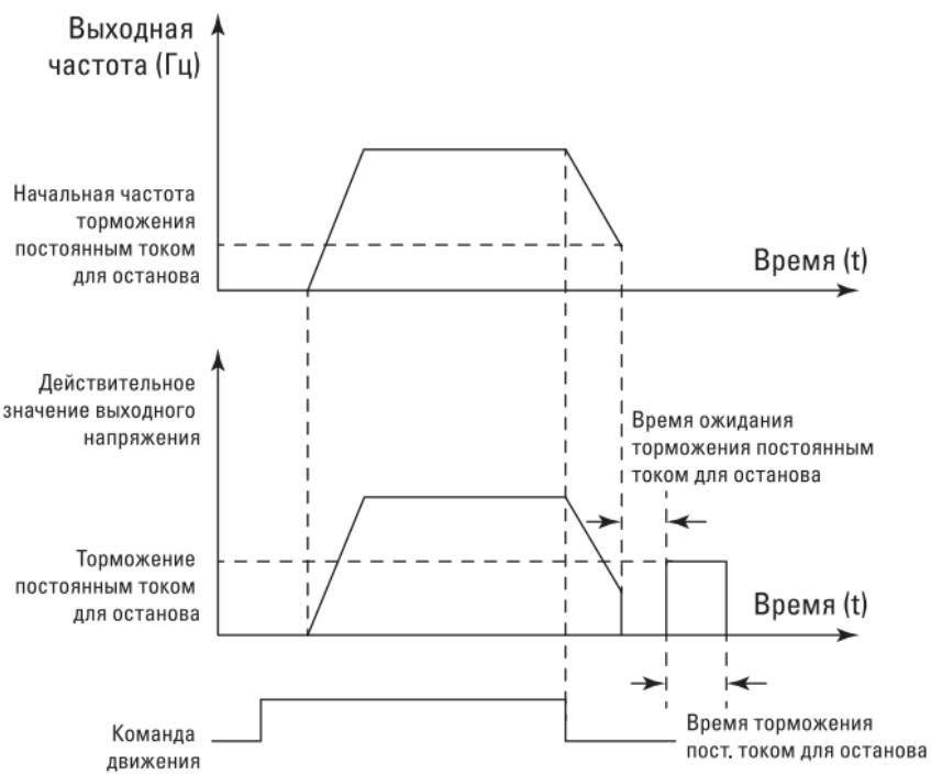
Рис. 6-13. Схема торможения постоянным током для останова
