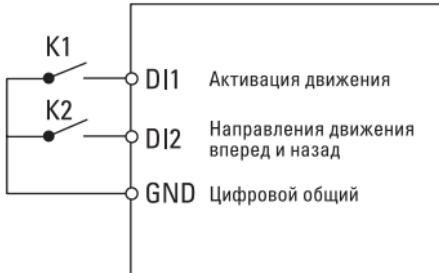
Рис. 6-7. Двухпроводной режим 2
