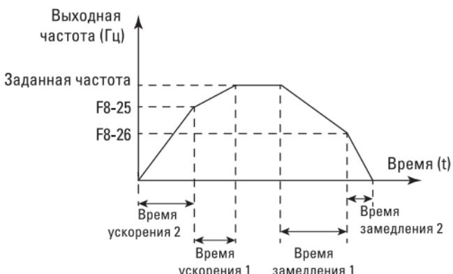
Рис. 6-19. Схема переключения времени ускорения/замедления
