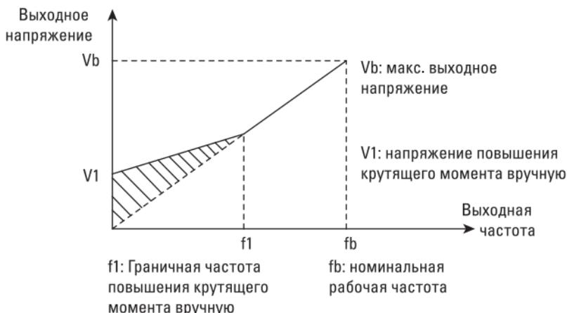
Рис. 6-3. Схема повышения крутящего момента вручную
