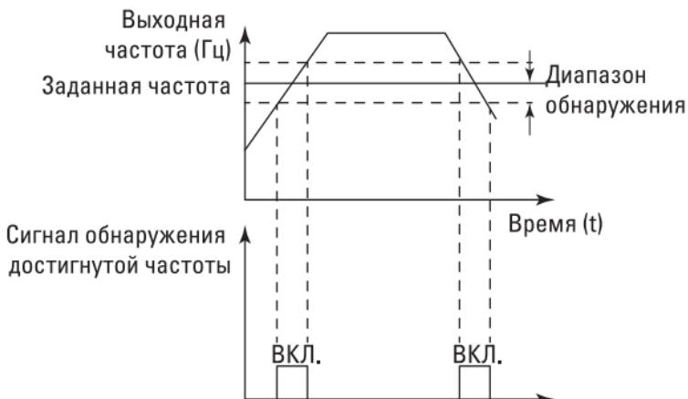
Рис. 6-17. Схема достижения обнаруженной амплитуды частоты
