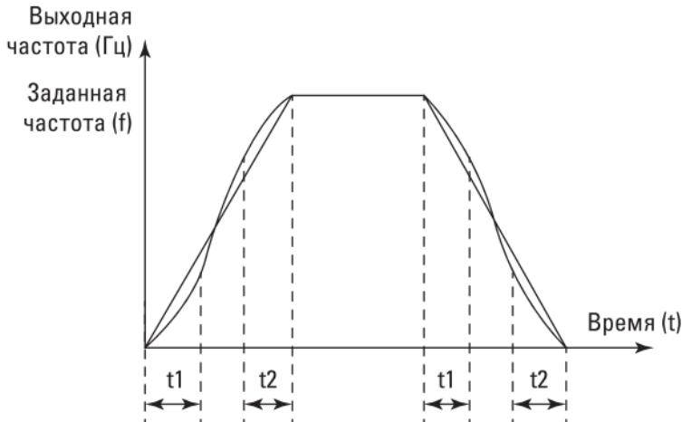
Рис. 6-11 Схема ускорения/замедления А для кривой S
