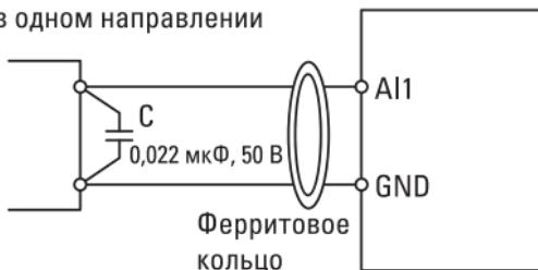
Рис. 3-9. Схема подключения обработки клеммы аналогового входа
