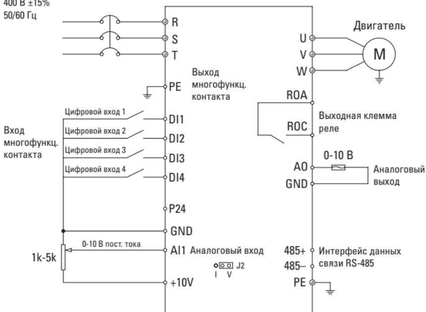
Рисунок 3-7 Схема подключения преобразователя частоты
