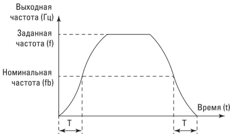
Рис. 6-12. Схема ускорения/замедления В для кривой S
