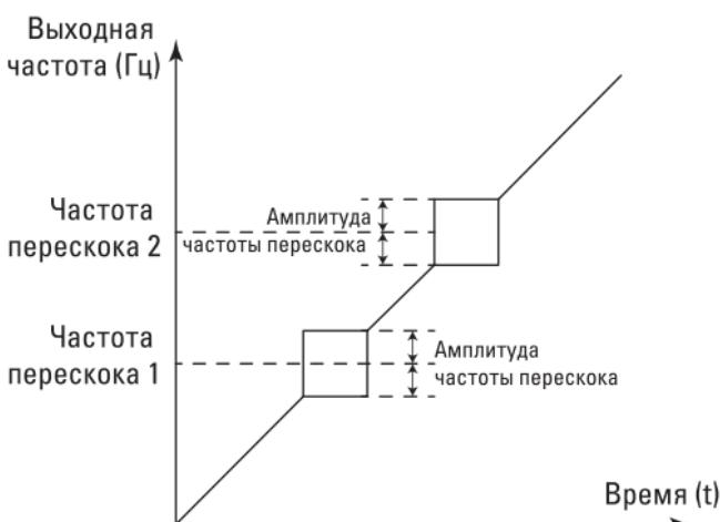
Рис. 6-14. Схема частоты перескока
