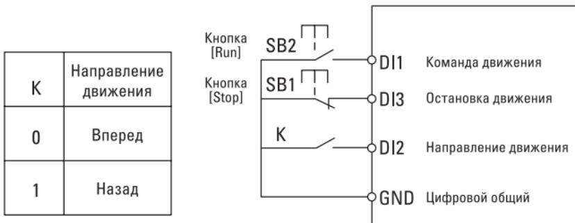
Рис. 6-9. Трехпроводной режим управления 2
