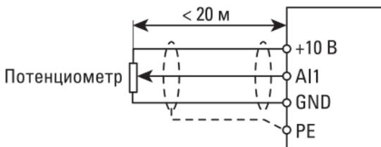
Рис. 3-8. Схема подключения клеммы аналогового входа
