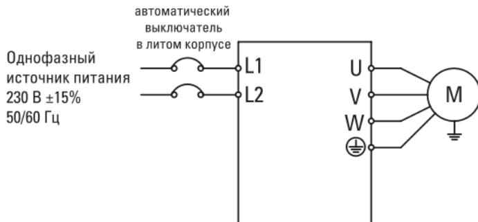
Рисунок 3-4 Стандартное однофазное подключение 0,75–1,5 кВт
