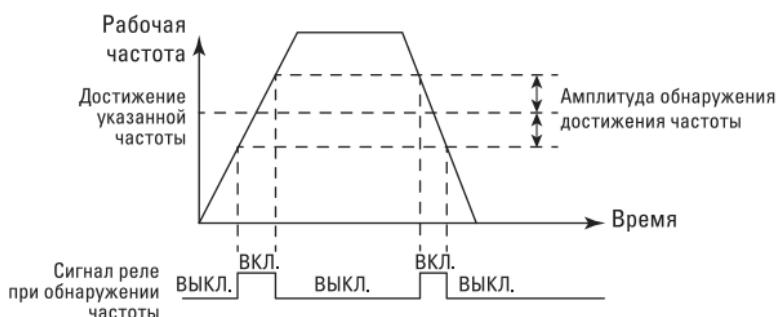
Рис. 6-20. Схема поиска произвольной достигнутой частоты
