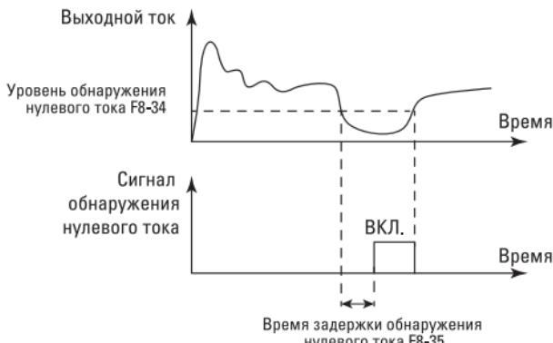
Рис. 6-21. Схема поиска нулевого тока
