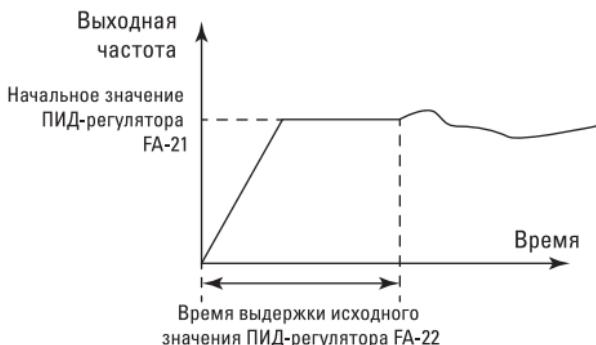
Рис. 6-28. Схема функции стартера ПИД-регулятора
