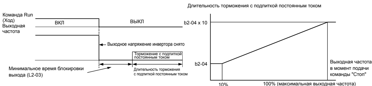
Рис. 6.16 Торможение с подпиткой постоянным током
