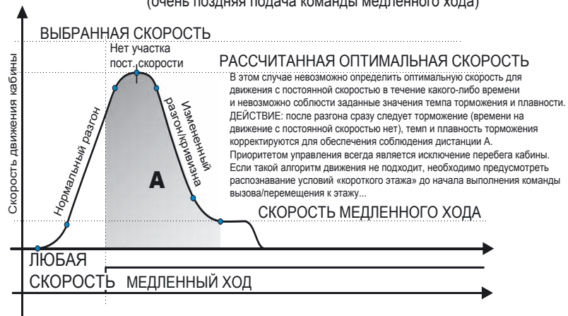
ФУНКЦИЯ «КОРОТКИЙ ЭТАЖ», СЛУЧАЙ 3 (очень поздняя подача команды медленного хода)
