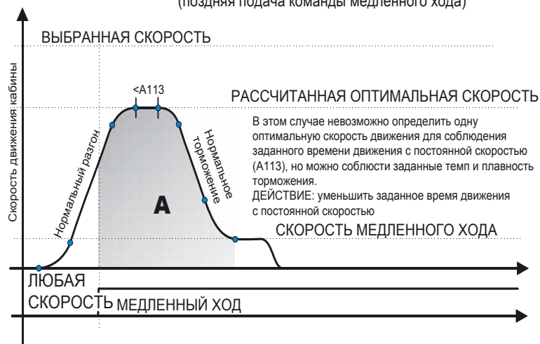
ФУНКЦИЯ «КОРОТКИЙ ЭТАЖ», СЛУЧАЙ 2 (поздняя подача команды медленного хода)
