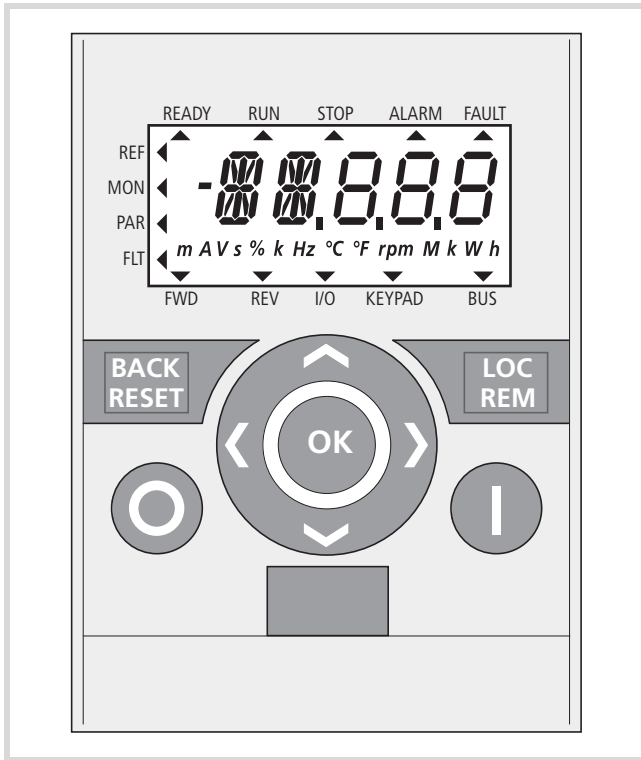
рисунок 63: Вид модуля управления с ЖК-дисплеем, функциональными клавишами и интерфейсом LCD = Liquid Crystal Display (жидкокристаллический дисплей)
