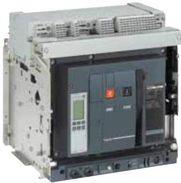
Автоматические выключатели Masterpact NW с повышенной защитой от коррозии разработаны для эксплуатации в промышленной среде с высоким содержанием соединений серы, например, в бумажных фабриках, нефтеперерабатывающих заводах, стеклоплавильных заводах, водоочистных системах и т.д., то есть на предприятиях с опасительными выбросами сернистого гидрида ( $\text{SO}_2$ ) или бисульфита ( $\text{H}_2\text{S}$ ).
