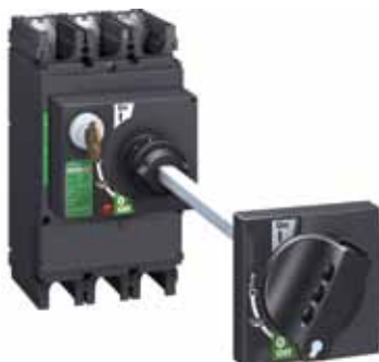
EasyPact EZC400 с выносной поворотной рукояткой. На лицевой панели установленного в глубине щита прибора — дополнительный встроенный замок с ключом
