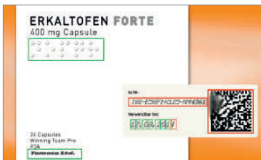
Проверка даты и кода партии (OCR/OCV)
