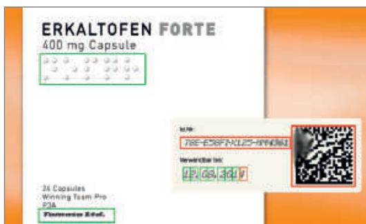
Проверка даты и кода партии (OCR/OCV)
