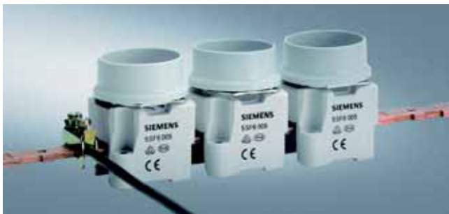
Навесные цоколи предохранителей DIAZED DII для 25 A, 5SF6 005 с исполнением зажимов „B“ установлены на сборную шину EZR 5SH3 54. Подводящие провода закреплены при помощи навесного зажима 8JH4 122. Сборную шину можно нагружать до 150 A.
