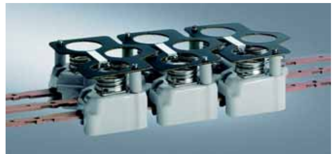
Трёхфазные навесные цоколи предохранителей DIAZED DII для 3 x 25 A, 5SF2 07 с исполнением зажимов „B“ установлены на 3 сборные шины EZR 5SH3 54. Каждую из сборных шин можно нагружать до 150 A.
