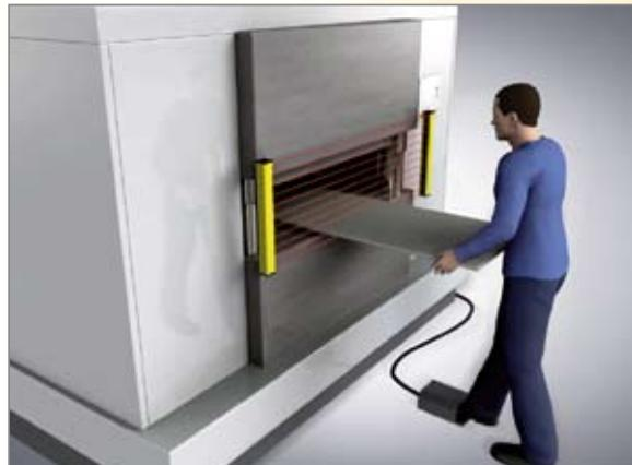
Фиксированное и плавающее гашение лучей является стандартной функцией модели с расширенной функциональностью.
