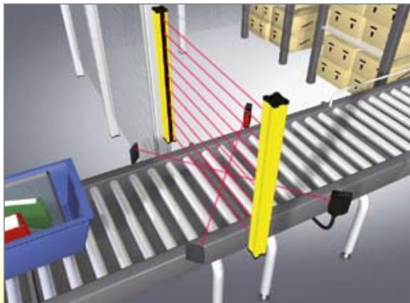
Система селективного пропуска на автоматизированном складе производственных материалов.
