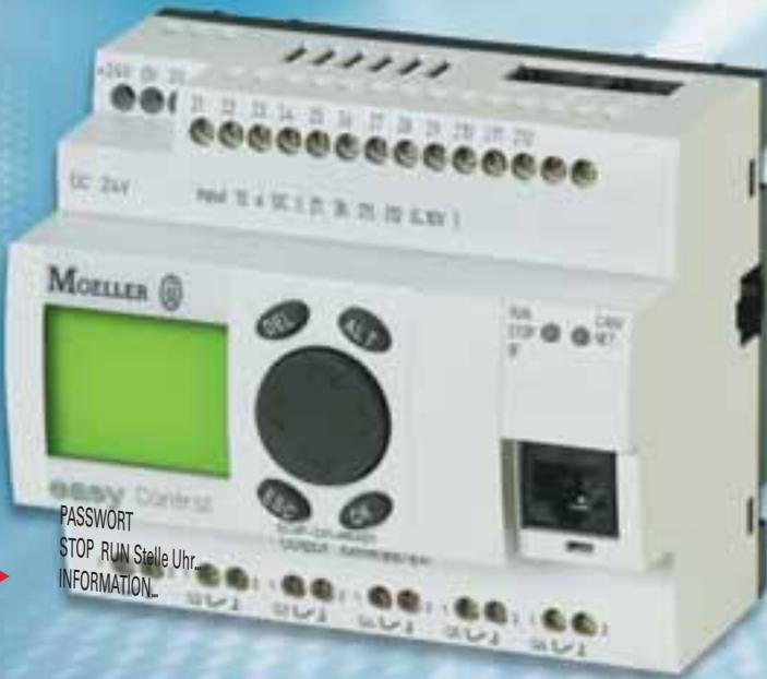
easyControl это логическое продолжение успешной истории easy. easyControl EC4P позволяет находить для пользователя простые решения задач малой и средней автоматизации и эффективно воплощать их в реальность. Этот контроллер может использоваться как в комбинации со стандартными easy системами так и практически с любыми контроллерами других производителей через встроенный интерфейс CANopen.
